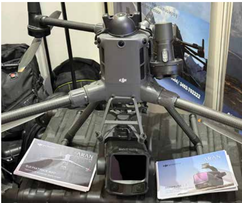
Arán Tecnologías integra drones equipados con tecnología LiDAR para relevamiento topográfico y generación de modelos digitales del terreno.
