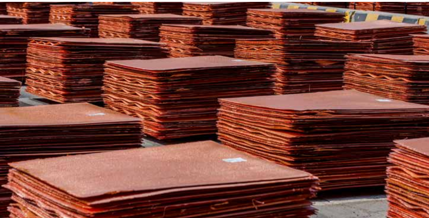
Cátodos de cobre, provenientes de los procesos de lixiviación y electro-obtención.
