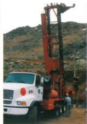
Trabajo de perforación por sistema de aire reverso y chuzador son una postal de Veladero, en pleno Valle del Cuzco.
