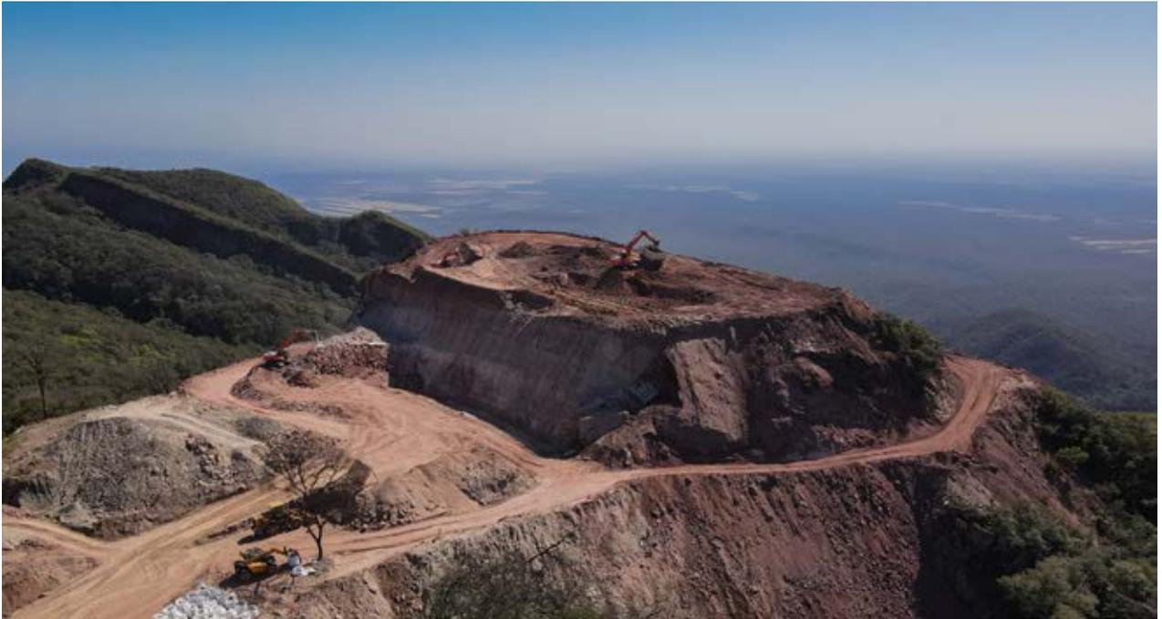
El proceso de extracción se realiza a partir de martillos hidráulicos montados sobre excavadoras
